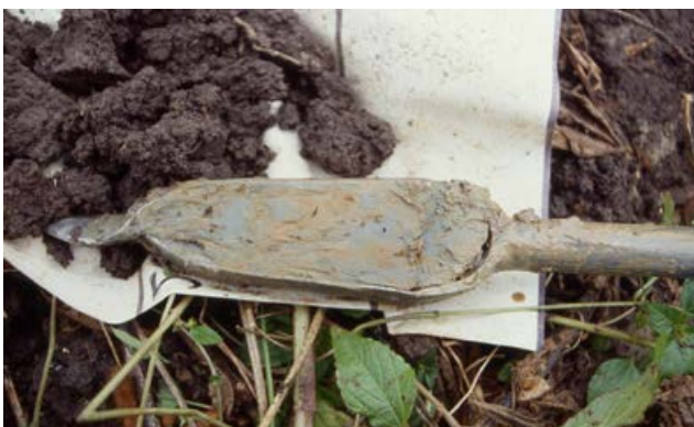
Figura 3.3: Trivellata eseguita con trivella olandese manuale; le carote di terreno estratte vengono posizionate su di un telo per consentire la descrizione degli orizzonti pedologici e il campionamento.
